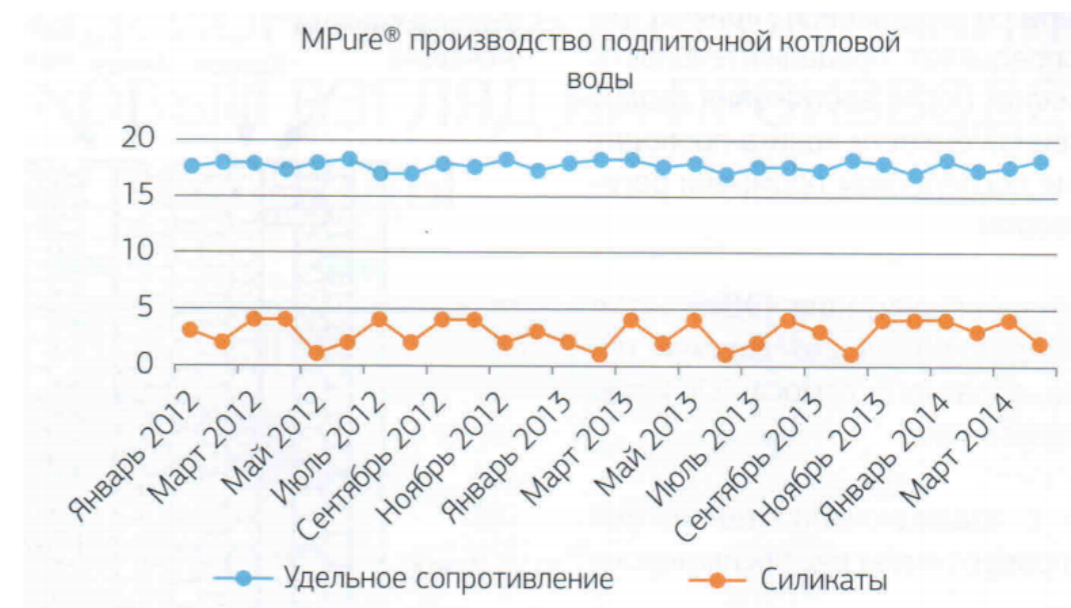
Рисунок 4 График производительности MPure® за 2 года эксплуатации.
